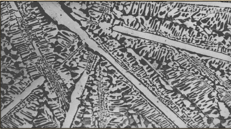
Długie wydzielienia cementytu pierwotnego na tle ledeburytu przemianego.
